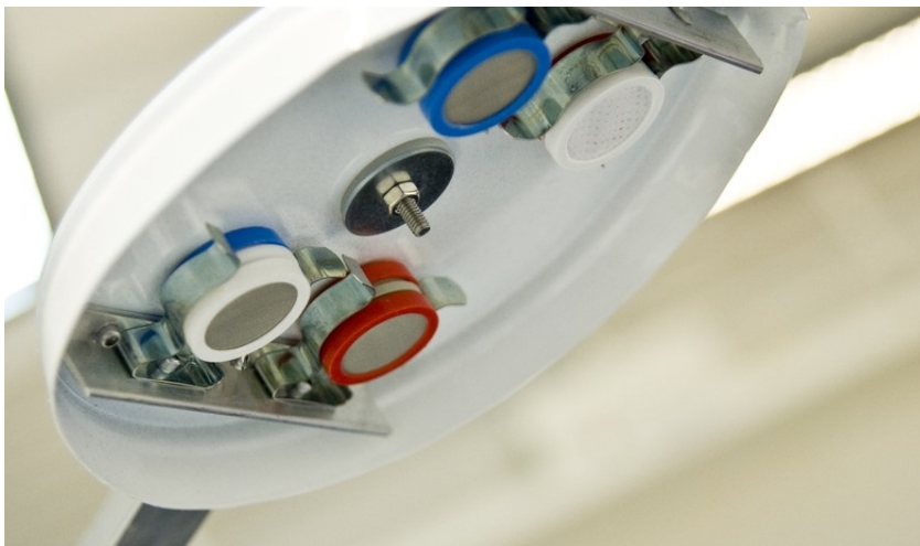
Figur 1. Utrustning för mätning med passivprovtagare. De färgade plastknapparna är de passiva provtagarna. Källa: IVL Svenska Miljöinstitutet AB.
